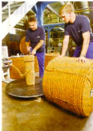
Bild 2 Die FaserTec-Anlagen werden mit Kokosfaser-Coils beschickt
