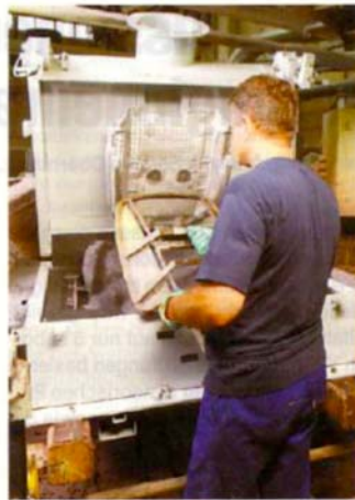
Bild 3 Der Wollwatteszuschnitt wird mittels einer Einlegehilfe und Vakuum eingelegt, um eine faltenfreie Oberfläche des Lehnepolsters zu erreichen
